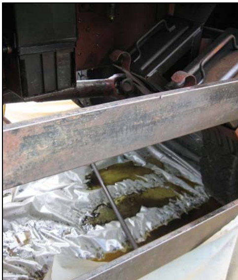
Abbildung 5-18: Verschmutzung von Grundstücken durch das Austreten wassergefährdender Stoffe (Maschinenöl) durch das Bohrgerät (Quelle TLUG).
