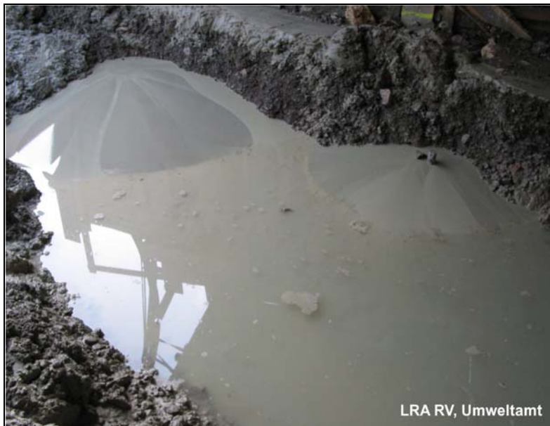
Abbildung 5-4: Artesischer Grundwasseraustritt mit Ausspülung von Feinmaterial.
